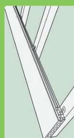
Der Clip verfügt über ein vorgefertigtes Bohrloch. Bohre durch dieses hindurch und befestige den Clip mit einer Schraube in der Mitte der Unterkonstruktion.
