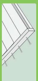
Wenn Du ein Abschlussprofil montieren willst, solltest Du zuerst die Vorbohrung durch das Profil hindurch in die Seite der Dielle oder der Unterkonstruktion setzen. So kannst Du das Profil anschließend bündig verschrauben.
