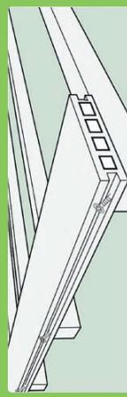
Bitte Sorge zu Beginn für einen geeigneten Untergrund, welcher ausreichend befestigt ist. Keine Staunässe aufweist und eine ausreichende Belüftung ermöglicht. Anschließend setze die erste Dielle außen auf Anterposition der Unterkonstruktion. Aufnahmebohrungen sollten in einem 45° Winkel zwischen die Nutwanngen der Dielle zentral in die Unterkonstruktion gesetzt werden. Prüfe, ob das empfohlene Gefälle von 2 % in Längsrichtung eingehalten wurde. Nun verschraube die Dielle.
