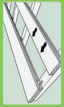
Anschließend setze die zweite Dielle an und schiebe diese mit sanifrem Druck gegen die Clips. Achte darauf, dass alle Clips in die Seitennut der nächsten Dielle passen.
