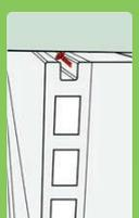
Bei der letzten Dielle gehe wie im ersten Schritt beschrieben vor - Aufnahmebohrungen im 45°-Winkel zwischen die Nutwanngen setzen und festschrauben.
